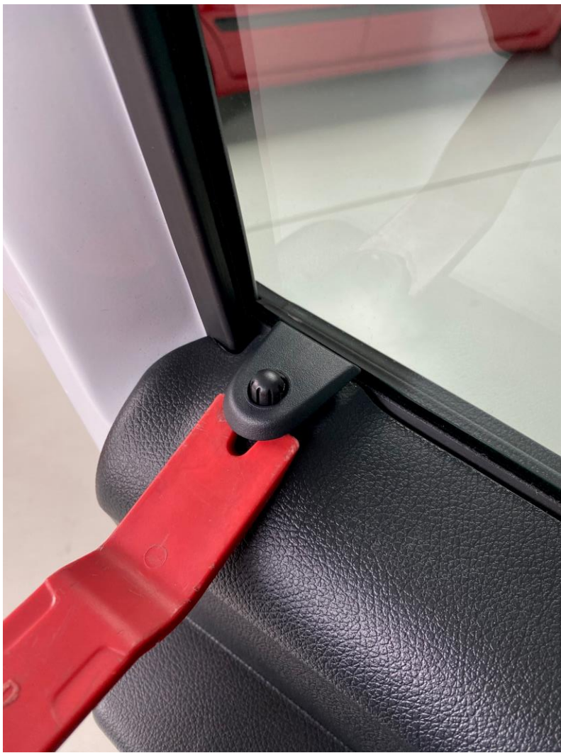
Die Abdeckung des Tür-Pins nach oben herauslösen.
