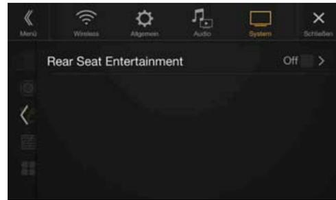
Wenn ein Fondmonitor mit HDMI-Eingang an dieses Gerät angeschlossen ist, ändern Sie die Einstellung in „On“. Sie können Bilder an den Fondmonitor ausgeben. Einzelheiten dazu finden Sie unter „Rear Seat Entertainment-Funktion“ (Seite 19).
