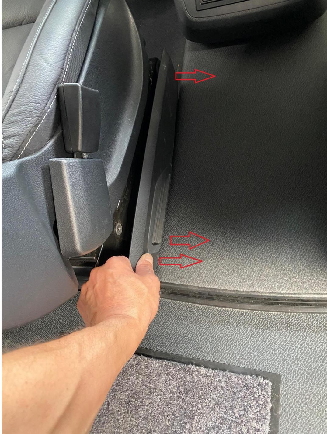
Bevor wir den Subwoofer montieren können, müssen die Sitzverschalungen an den Sitzkonsolen innen ausgebaut und entfernt werden. Dazu an den Ecken ziehen, bis die Befestigung herauspringt.
