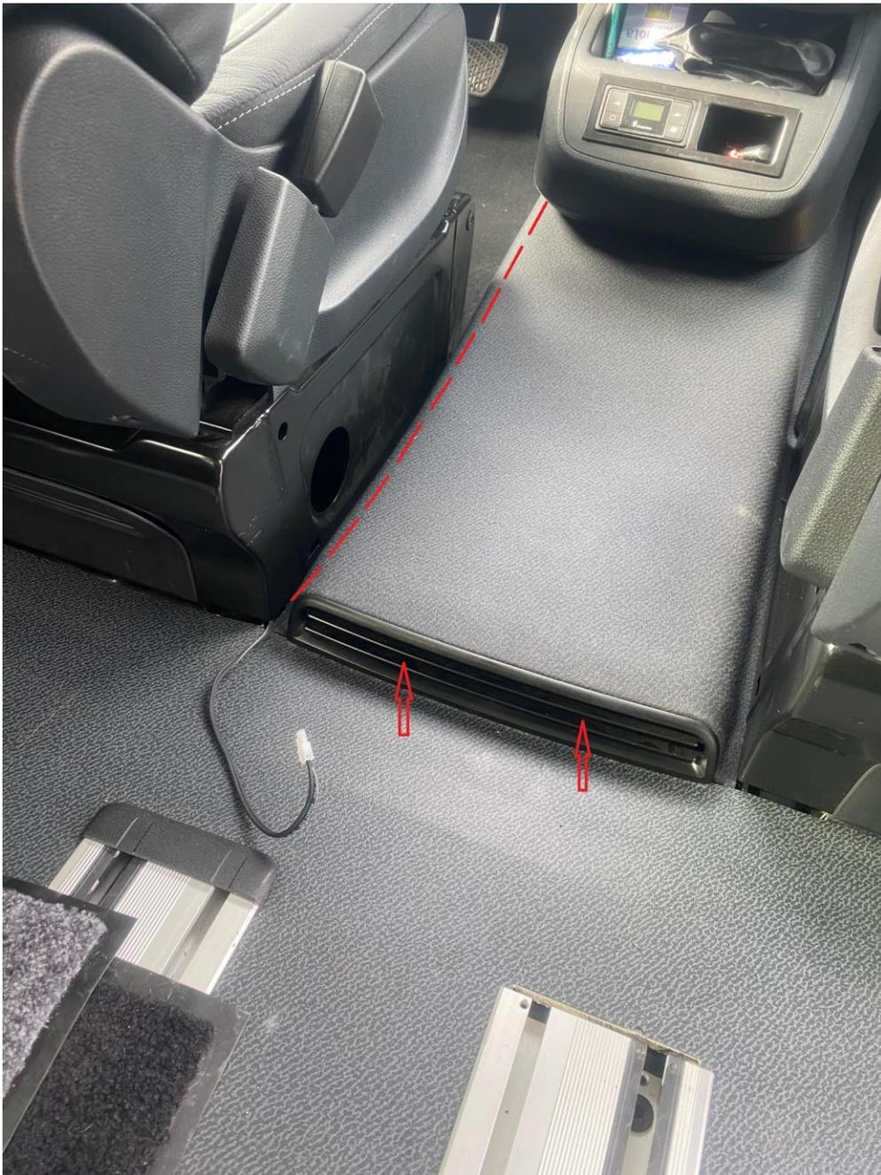
Das Kabel wird entlang der gestrichelten Linie verlegt, dazu entfernen wir zunächst die Luftaustrittsdüse, die mit zwei Torx-20-Schrauben an den mit Pfeilen gekennzeichneten Stellen angeschraubt ist. Danach lässt sich das Kabel mit dem beiliegenden Durchziehband einfacher verlegen. Nach dem Verlegen Lüftungsdüse wieder einsetzen und Anschrauben. Die Kabelaustrittsstelle sollte nah der Heizungsansaugung liegen, damit der Subwoofer nicht draufsteht.
