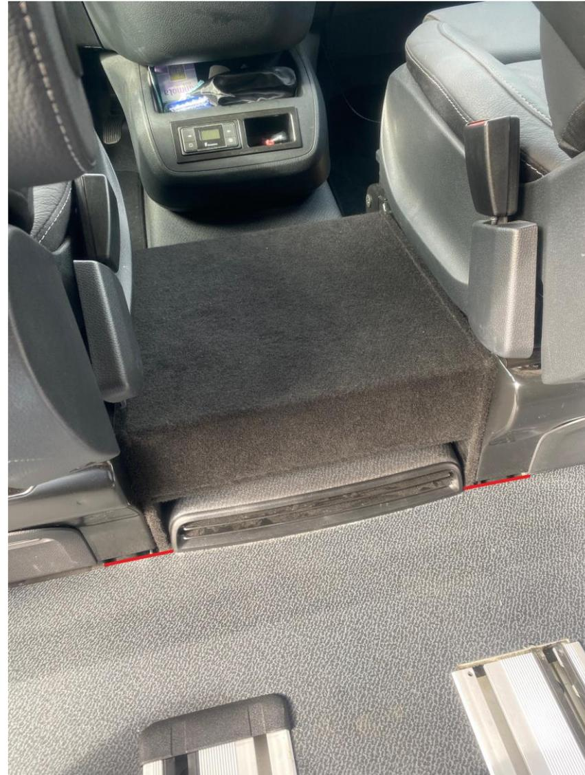
Das Gehäuse ist vollständig eingeschoben, wenn die Seitenplatten mit der Konsolenenden unten fluchten.
