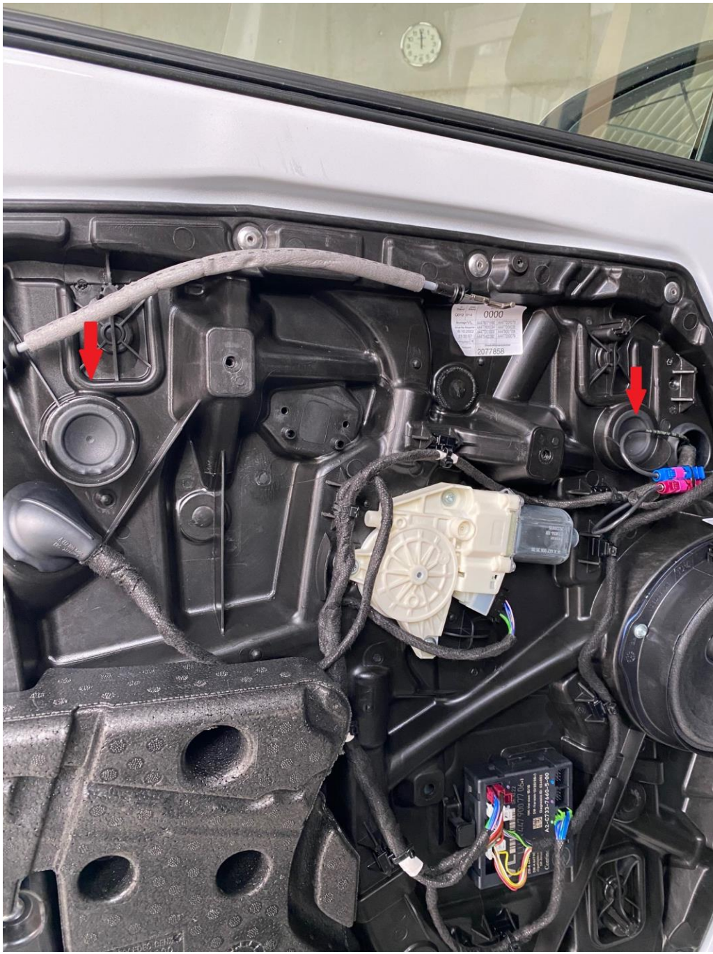
Zwei Gumm- Abdeckkappen lösen/entfernen
