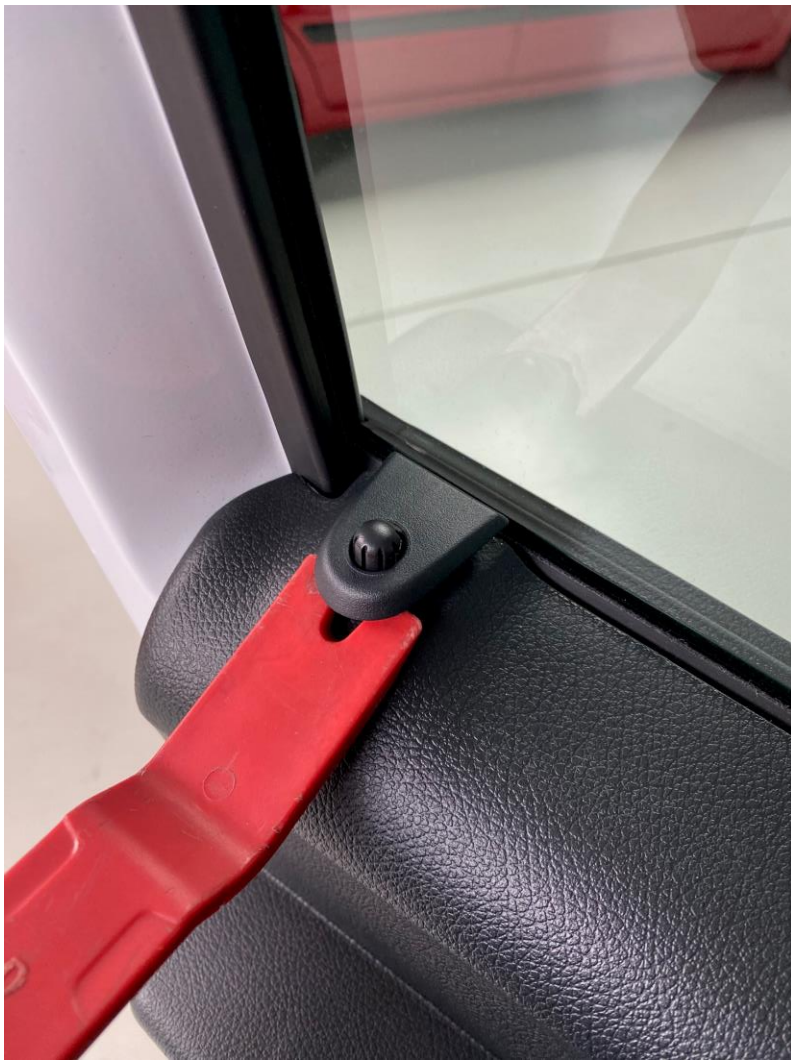
Die Abdeckung des Tür-Pins nach oben herauslösen.
