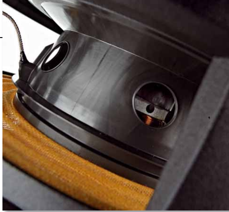
Durch das Bullauge sieht man Schwingspule, gelochten Träger und dessen Verbindung zur Membran. Der 10TW1 ist maximal flach gebaut
